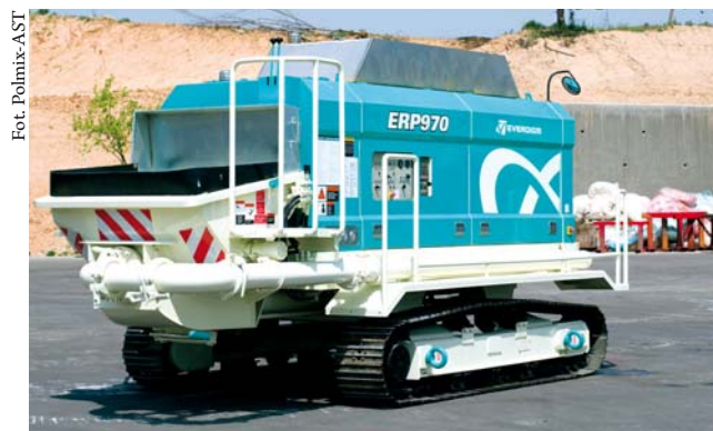
→ Pompa samojezdna na podwoziu gąsienicowym Everdigm ERP 970
