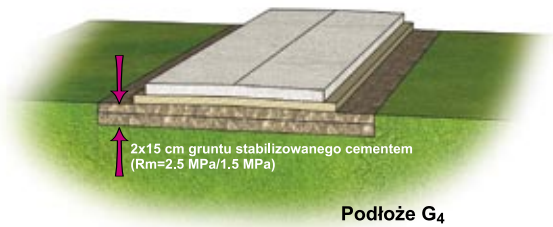
Rys. 3.3. Wzmocnienie gruntu podłoża za pomocą stabilizacji
